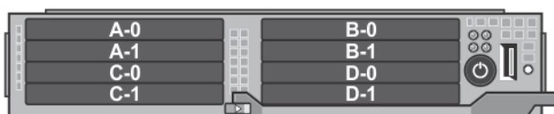
Ilustración 18. Numeración del compartimento SSD: sistema SSD de 1,8 pulgadas
